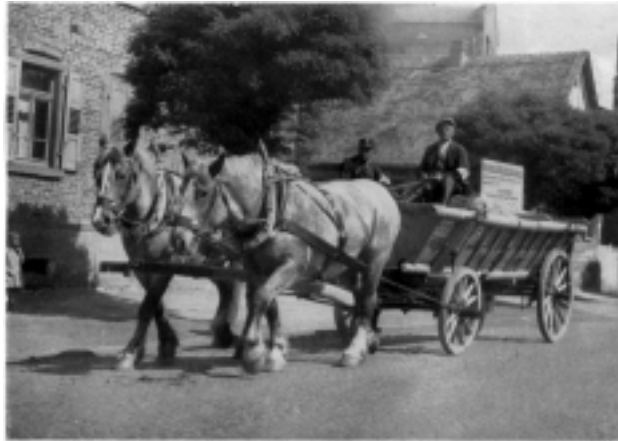
Dauerleistungsprüfung über 60 km mit 100 Ztr. Last.
