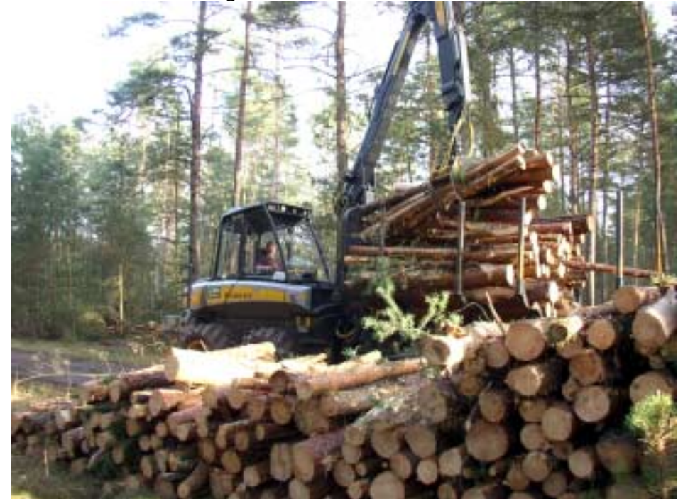
Der zweite Mann des Einschlagteams sammelt mit diesem Gerät das Holz ein und stapelt es am Weg für die Abfuhr.
