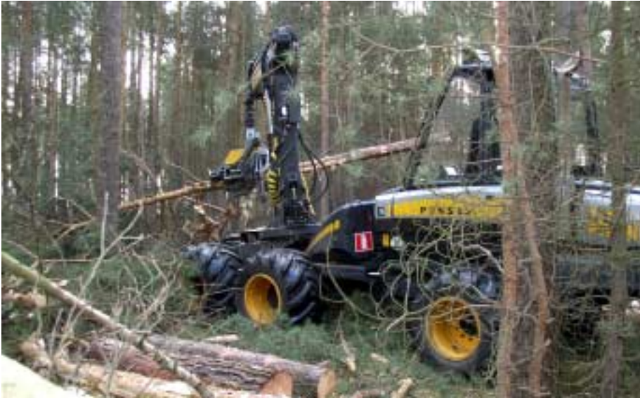
Diese Maschine fällt den Baum, entastet ihn und sägt den Stamm in Stücke.
