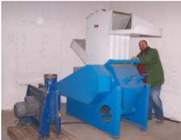
In dieser Maschine werden Kunststoffe zerkleinert.
